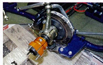
SuperVkartens främre hjulupphängning är hämtad från Superkart.
